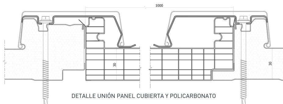
DETALLE UNIÓN PANEL CUBIERTA Y POLICARBONATO
