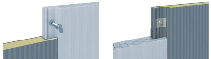
DETALLE ENTREGA ENTRE PLACAS DE POLICARBONATO - PANEL METÁLICO
