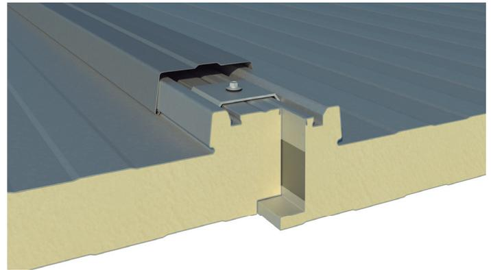
Detalle de Unión de Paneles con Tapajunta
