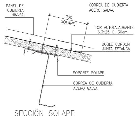
DETALLE PANEL HIANSA 5 GR ST. VÁLIDO PARA CUALQUIER TIPO DE PANEL DE CUBIERTA HIANSA ST.
