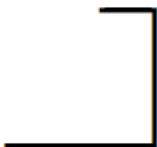
Remate de borde de forjado (R1) - LINEAL
