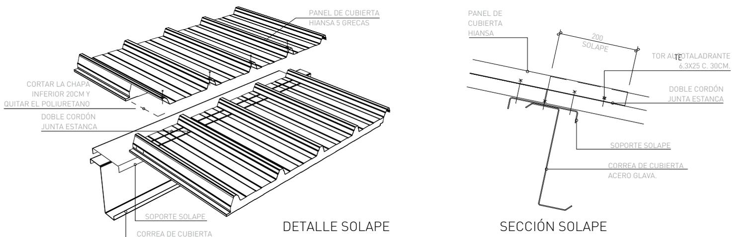
DETALLE PANEL HIANSA 5 GR ST. VÁLIDO PARA CUALQUIER TIPO DE PANEL DE CUBIERTA HIANSA.
